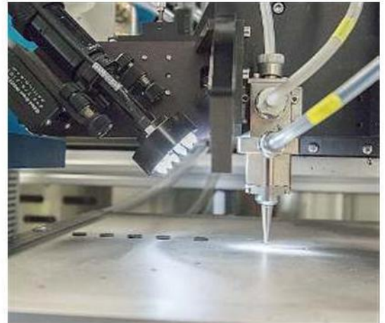
La macchina. L'aerosol jet al lavoro a Ingegneria
